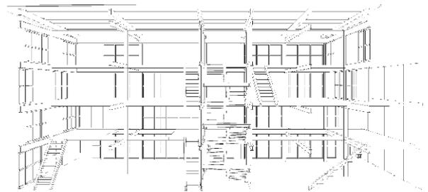
IMAGENS 1 e 2\_ Além dos componentes estruturais principais, perfis e chapas de aço são utilizados para a estruturação de diversos componentes: guarda-corpos, marquises, gradis e escadas. Nestas, chapas metálicas são dobradas em peças que formam as pisadas e espelhos; na direção longitudinal a estrutura principal são duas vigas de borda em chapa de aço cortadas de forma a ajustar-se ao desenho das pisadas; as ligações entre os componentes são soldadas.
