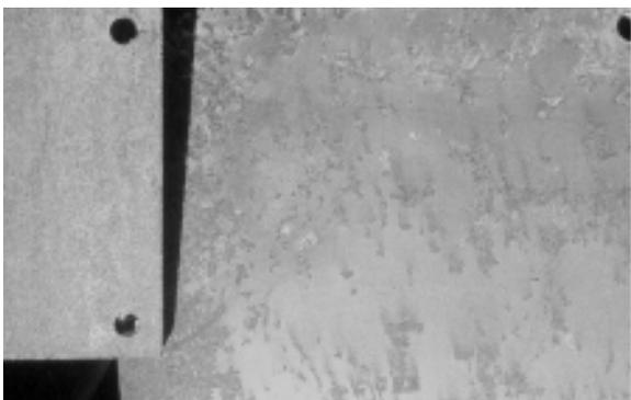
Figura 1.5 - Chapa de aço laminado a quente com presença da carepa e da ferrugem
