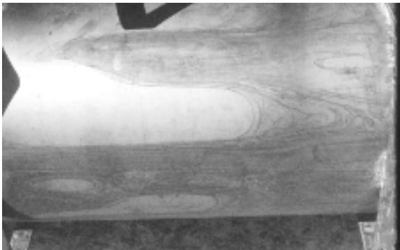
Figura 1.4 - Chapa de aço laminado a quente com presença da carepa
