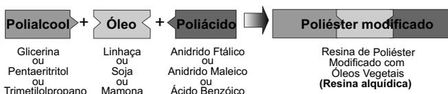
Figura 3.2 - Esquema simplificado de obtenção da resina alquídica
