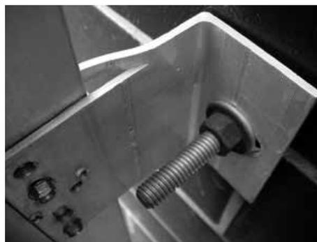
Figura 1.5. Corrosão apresentada por porca e arruela de aço galvanizado em contato com chumbador de aço inox e cantoneira de alumínio. (Acervo Inovatec Consultores)
